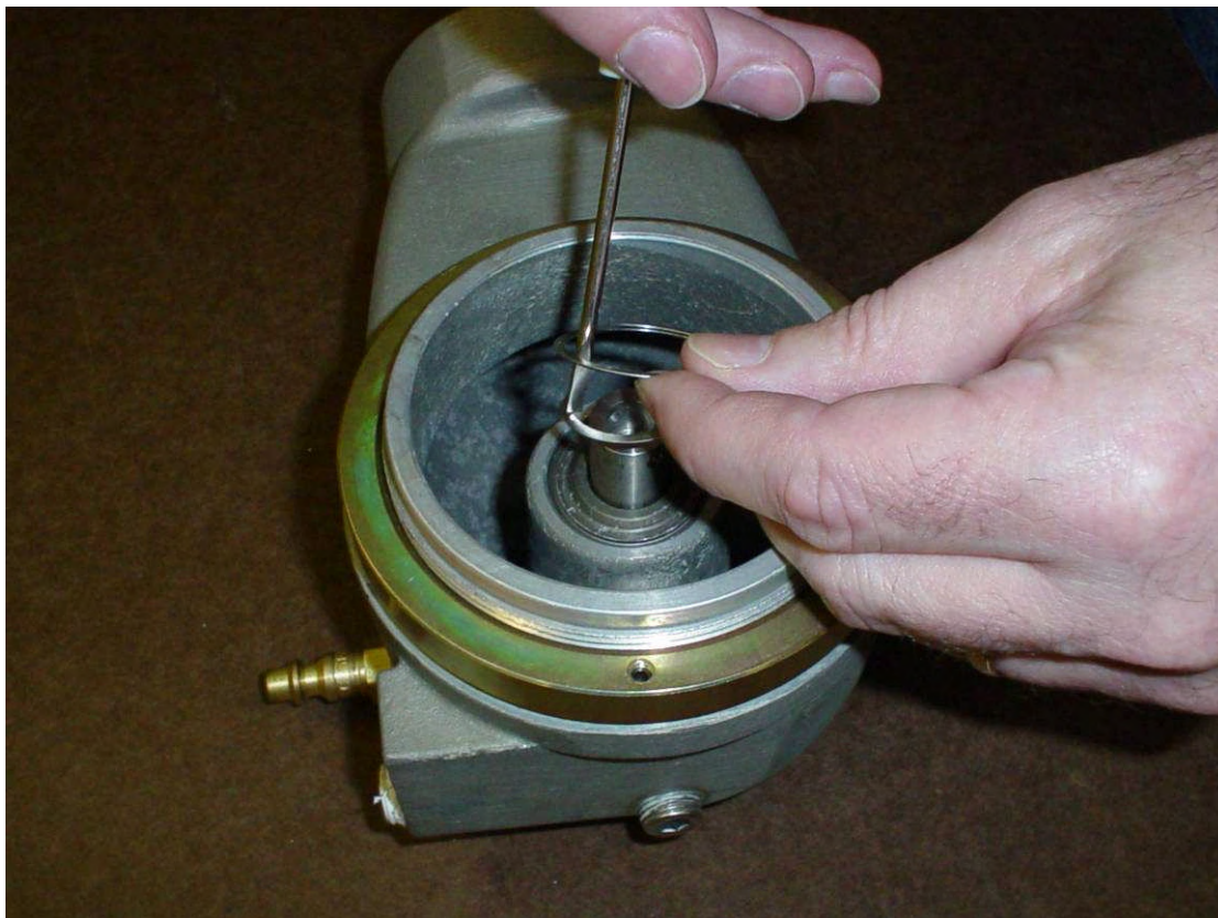
Figure 7 – installation de l'anneau de retenu
